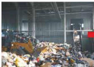
Колесные погрузчики перемещают отходы на конвейерные ленты, по которым они попадают в компактеры .
