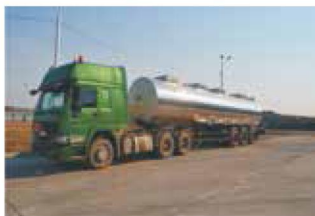
Автоцистерна предназначена для перевозки фильтрата, выкачиваемого из «тела» полигона для переработки на очистных сооружениях канализации МУП города Хабаровска «Водоканал».
